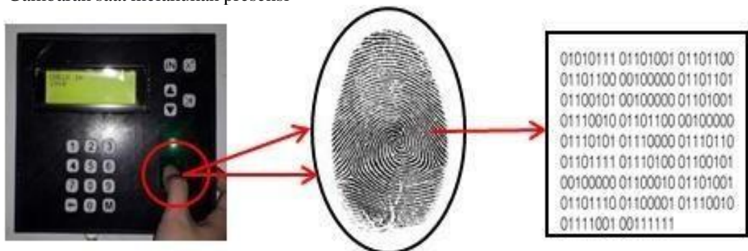
Gambar 9. Gambaran saat melakukan presensi sidik jari pada fingerprint dengan metode optical scanning .
