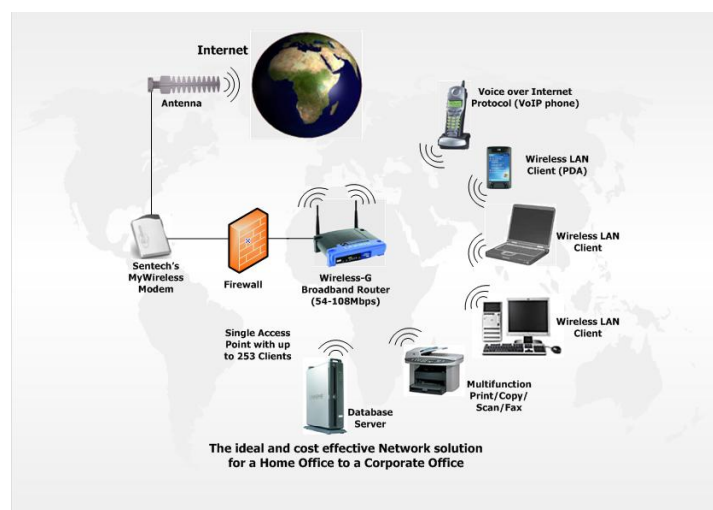
Gambar 2 Elemen dalam Jaringan Nirkabel
